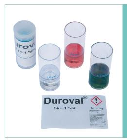
Avant de mesurer, vérifiez si votre trousse de tests a toujours une date de péremption valide. Si elle est périmée, veuillez nous contacter pour en obtenir une nouvelle. Remplissez maintenant le petit récipient d'eau jusqu'au repère bleu. Ajoutez ensuite une goutte du liquide de test et agitez. L'eau est maintenant rose. N'oubliez pas de déjà compter cette goutte. Comptez maintenant les gouttes en agitant constamment jusqu'à ce que l'eau change de couleur et devienne verte.
