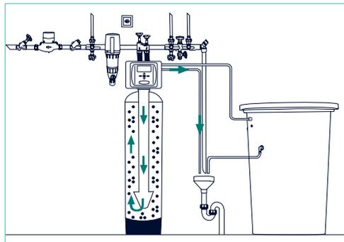
L'installation va maintenant effectuer un contre-lavage du lit de résine pour éliminer le sel résiduel de l'installation.
