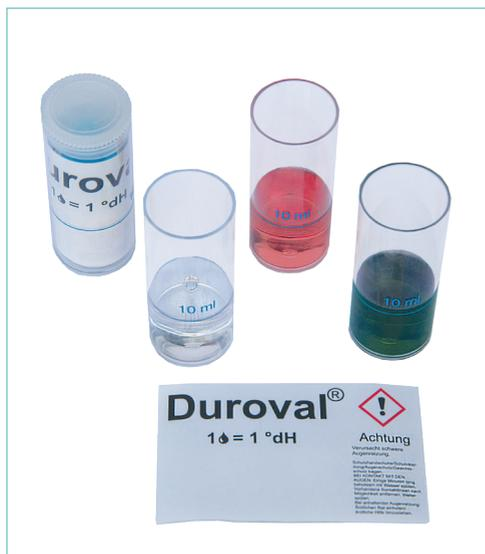
Avant de mesurer, vérifiez si votre trousse de tests a toujours une date de péremption valide. Si elle est périmée, veuillez nous contacter pour en obtenir une nouvelle. Remplissez maintenant le petit récipient d'eau jusqu'au repère bleu. Ajoutez ensuite une goutte du liquide de test et agitez. L'eau est maintenant rose. N'oubliez pas de déjà compter cette goutte. Comptez maintenant les gouttes en agitant constamment jusqu'à ce que l'eau change de couleur et devienne verte.
