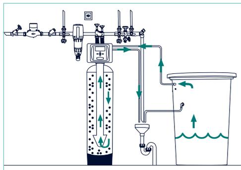
Le lit de résine est maintenant salé avec la saumure dissoute pour restaurer la capacité d'échange de la résine.
