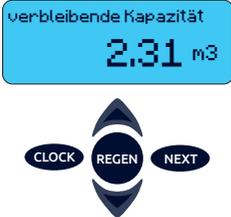
Bei dieser Anzeige wird Ihnen die restliche Kapazität angezeigt (in Kubikmetern).
